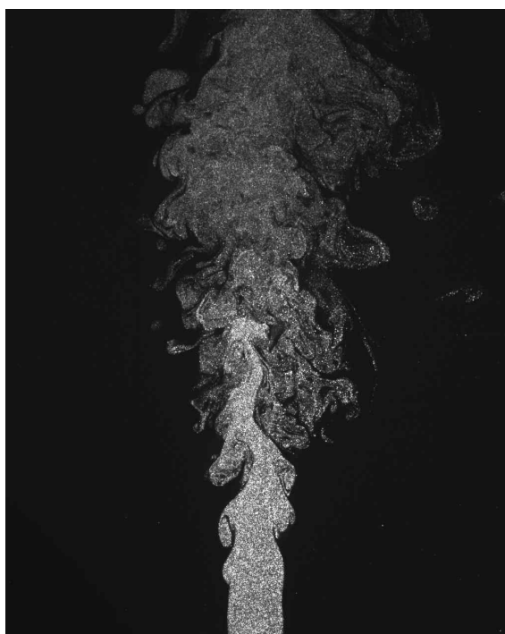
Figura 14. Singola immagine PIV che evidenzia la struttura del getto.
